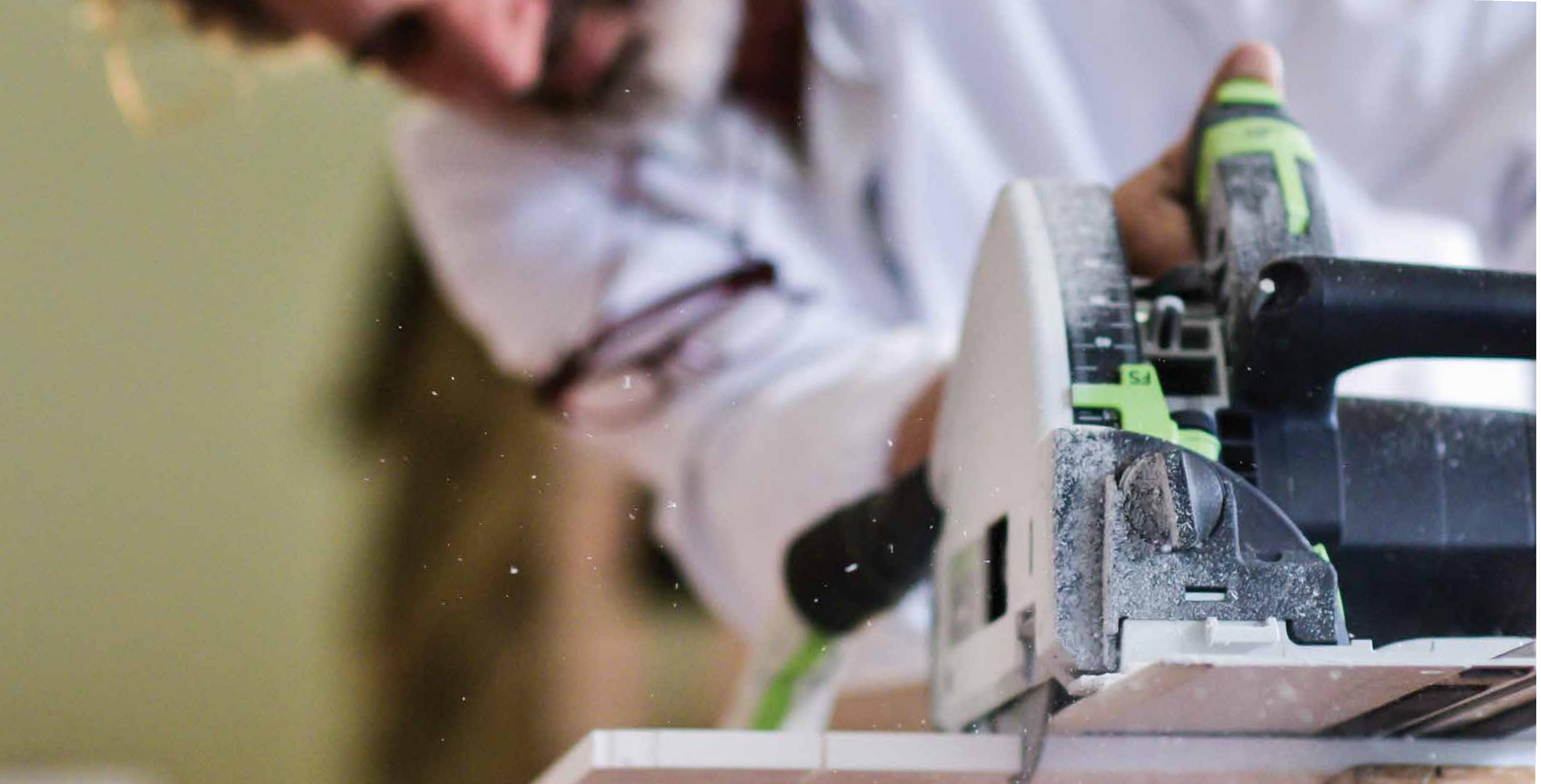
MECANIZABLE CON HERRAMIENTAS PARA LA MADERA
